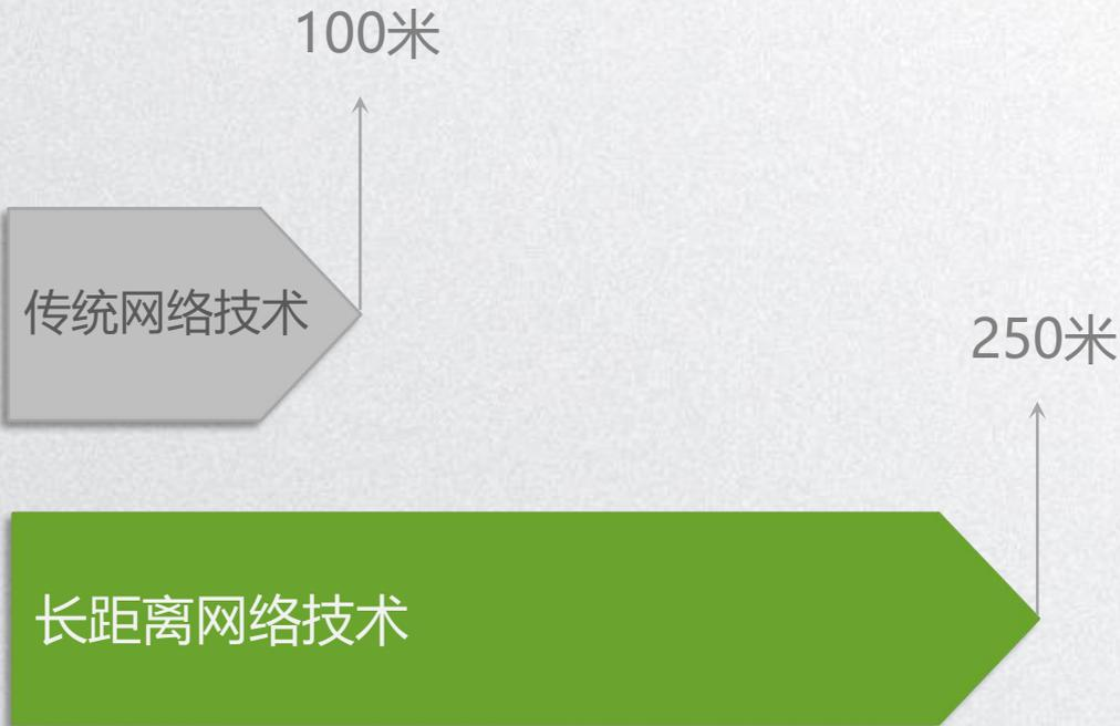
突破传统双绞线传输100米的距离限制，采用国标超五类双绞线，实现250米无中继的数据及供电传输，将双绞线传输的覆盖范围增加了1.5倍。
